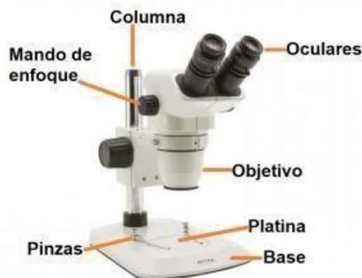
Figura 1. Imagen de un microscopio estereoscópico o Lupa binocular y sus partes. Extraído de https://productos.avantijobs.com/microscopio-estereoscopico/
