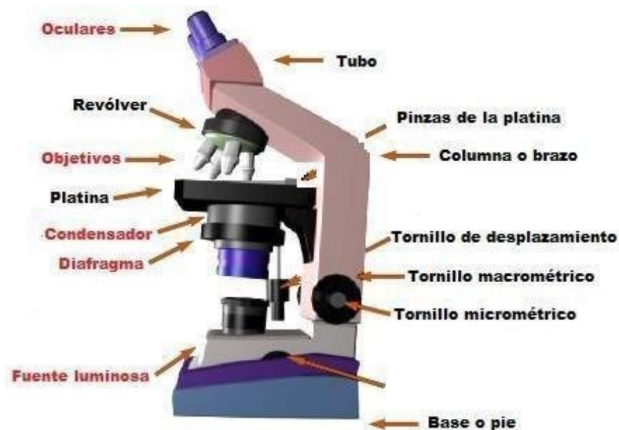
Figura 2. Imagen de un microscopio óptico y sus partes. Extraída y modificada de https://mmegias.webs.uvigo.es/6-tecnicas/6-optico.php y modificada.
